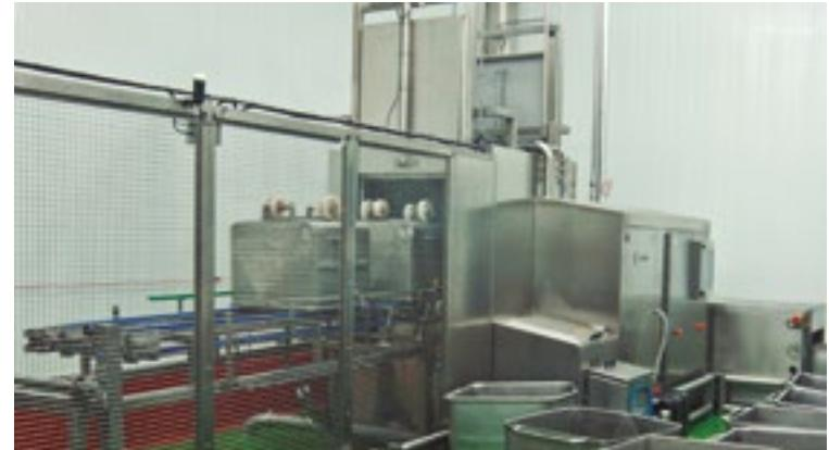
Las lavadoras de carros cúter pueden fabricarse en sistemas continuos con varios módulos de prelavado, lavado, aclarado recirculado, etc. o sistemas tipo "batch". El programa de lavado se puede adaptar en función del nivel de suciedad.
